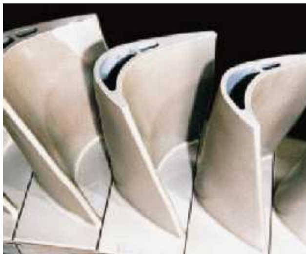
Lopatky spalovací turbíny řady MS5002 od GE s chladicími kanály [Anon., 2011]
