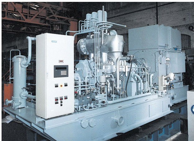
989: Příklad turbosoustrojí s parní turbínou a základním příslušenstvím na společném rámu
